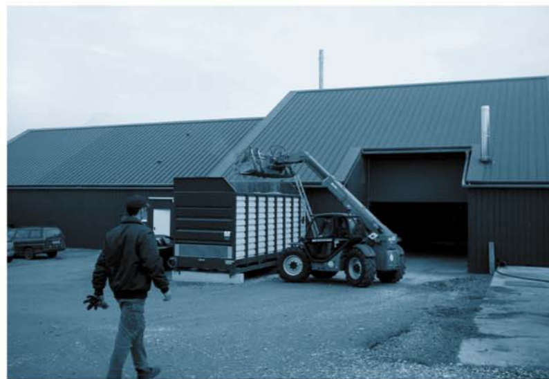
links: Beschickung des Vorlage- behälters des Bandrockners auf der Biogasanlage Nusbaum- Freilingen
